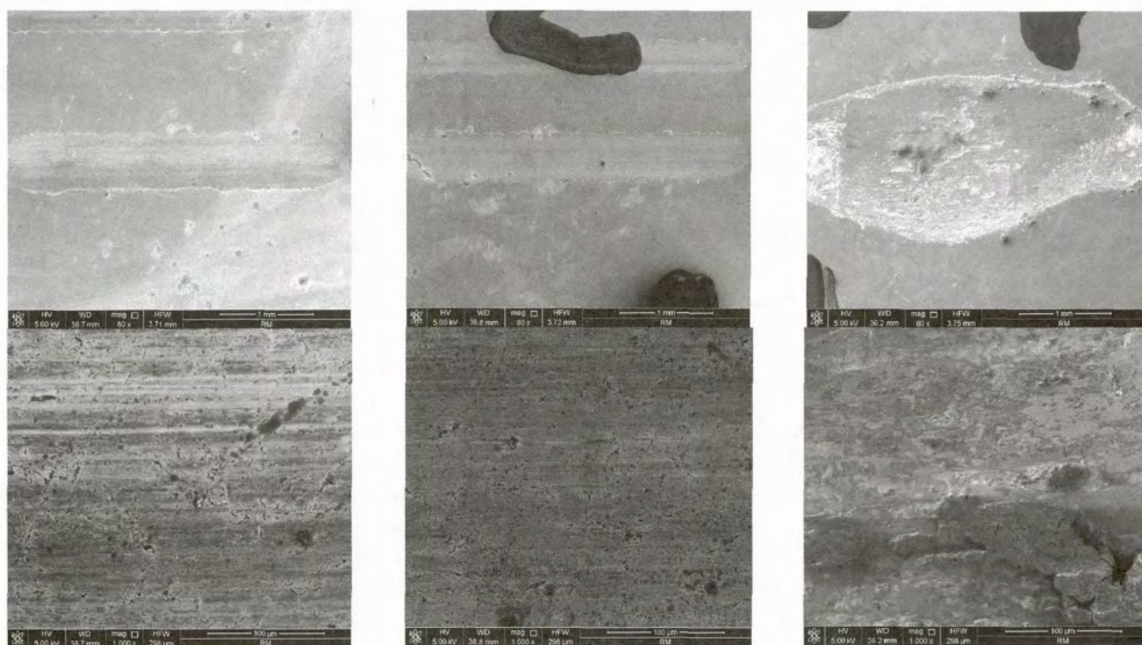
(a) 高碱值复合磺酸钙基脂润滑时磨痕表面形貌 (b) 含2% LiBF 4 导电润滑脂润滑时磨痕表面形貌 (c) 商用电力复合脂润滑时磨痕表面形貌
